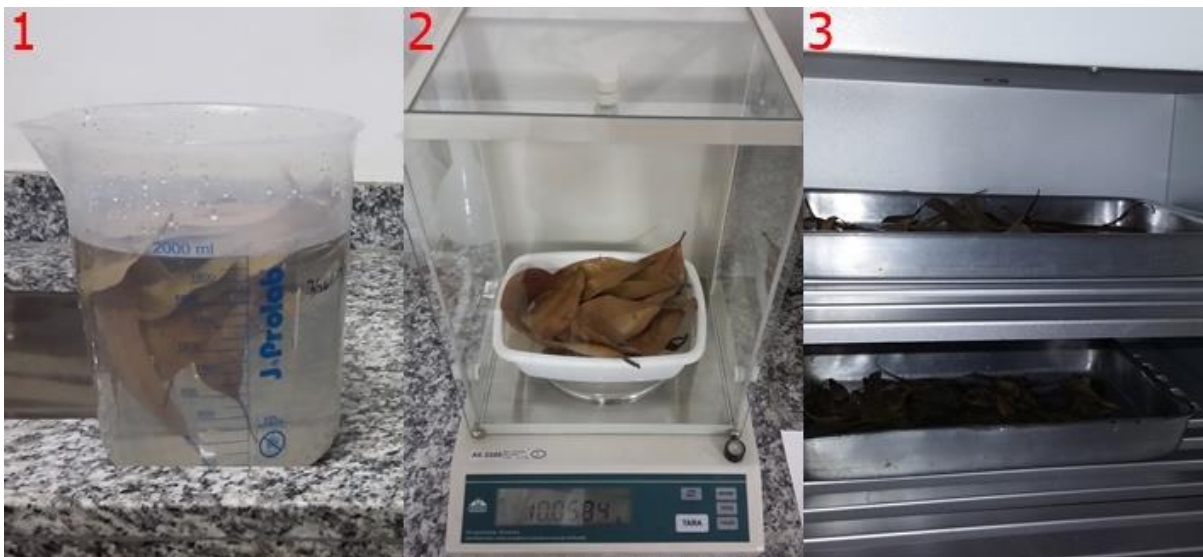
Figura 5: Processos realizados em laboratório para mensuração da capacidade de retenção hídrica do material amostrado: 1 - Material imerso na água; 2 - Pesagem do material úmido; 3 - Secagem em estufa, para posterior pesagem do material seco.
