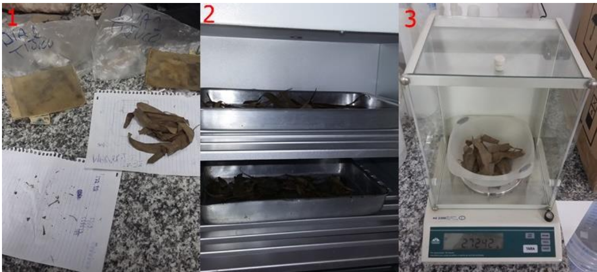
Figura 4: Processos realizados em laboratório, para mensuração da perda de massa da serrapilheira foliar das amostras: 1- Triagem do Material; 2 - Secagem em Estufa; 3 - Pesagem do material.
